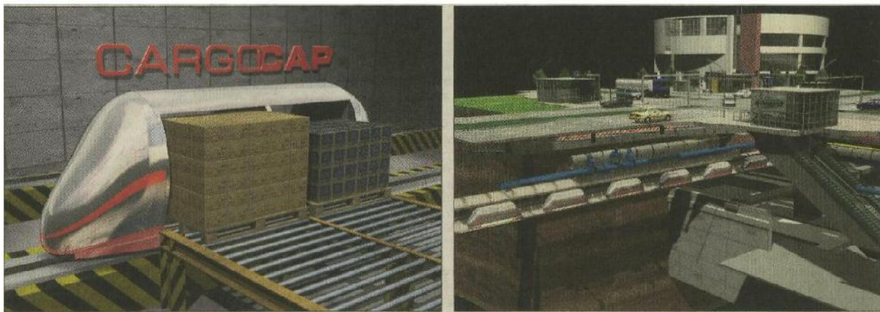
Die graphische Darstellung einer Kapsel von Cargo Cap mit Platz für zwei Europaletten und die Skizze einer Transportröhre. (Visaplan GmbH)
